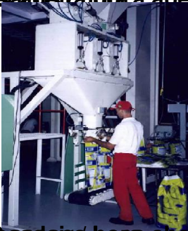
E04 Ensacadeira boca aberta com pré-pesagem
